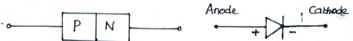
Fig. 2. PN DIODE SYMBOL
